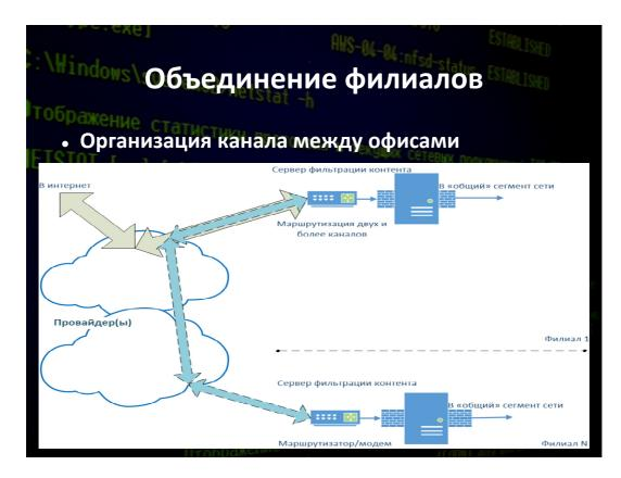
Для объединения филиалов через каналы связи с провайдерами создается «тоннель», по которому передаются зашифрованные данные. Технологии создания тоннеля выбираются на основе местных условий и проработки вопроса с провайдерами. При создании тоннеля необходимо выполнение ряда технических требований; возможно потребуется дополнительное оборудование.
